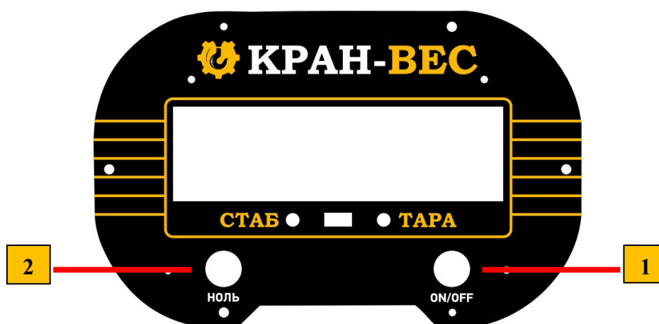
Рисунок 2. Общий вид передней панели весов КС.3
